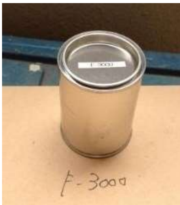
エイトシール F-3000 (ハケ塗 2 回) 塗装 (設置時)
